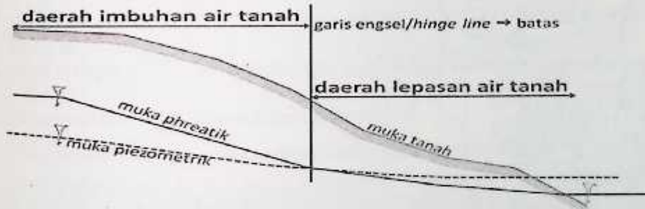
a. Skema daerah imbuhan dan daerah lepasan air tanah serta batasnya
