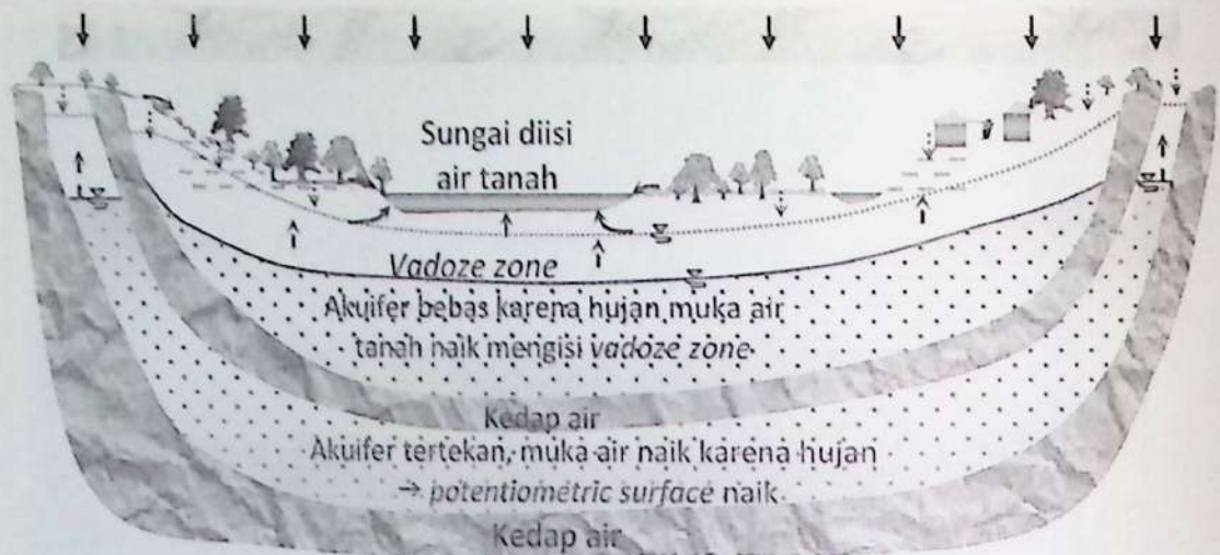
Gambar 5-14. Potongan CAT: akuifer tertekan dan akuifer bebas (Kodoatie, 2009d)
